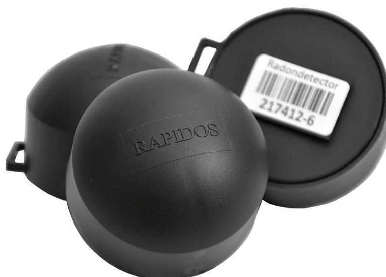
Figura 9. Detector de traços de partículas alfa (DTPA). Um dos dispositivos de medição do gás radônio mais comumente usado em diversos países.
