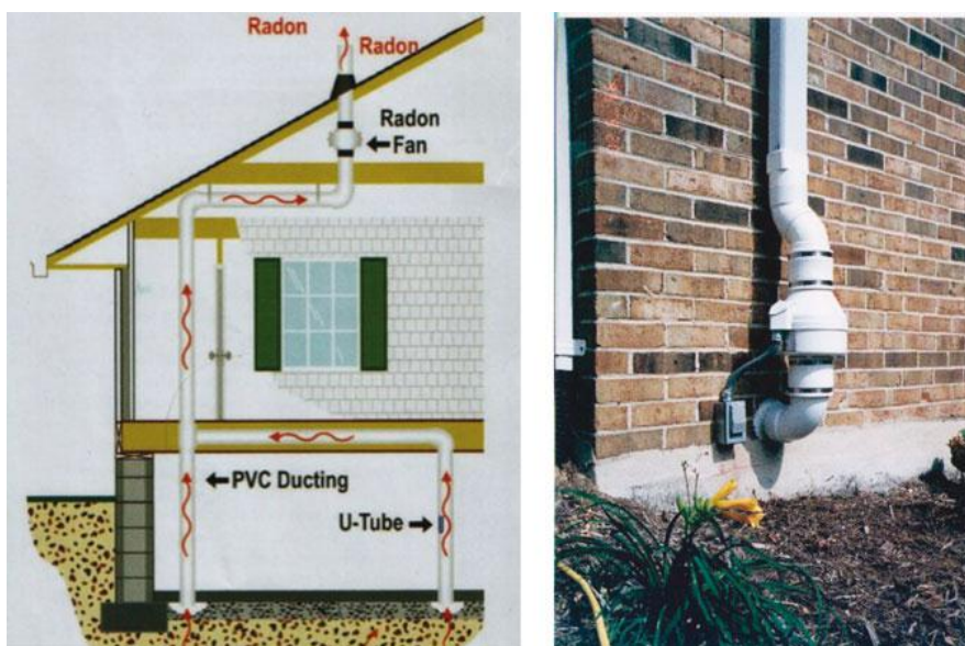
Figura 13: Despressurização ativa: pelo interior (esquerda) e pelo exterior (direita).
