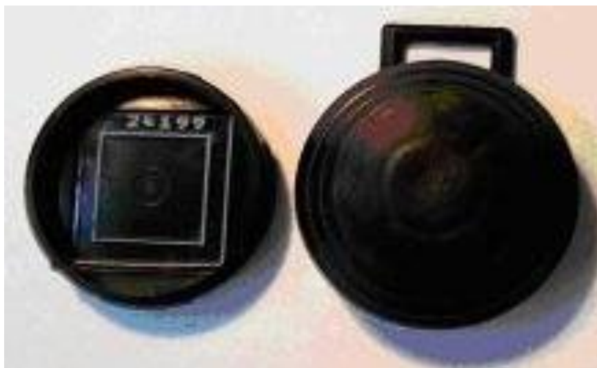
Figura 10. Dispositivo de medição do radônio aberto (esquerda) mostrando o polímero detector em seu interior (CR-39).
