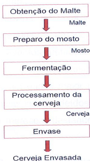
Figura 17 – Esquema geral da produção de cerveja
