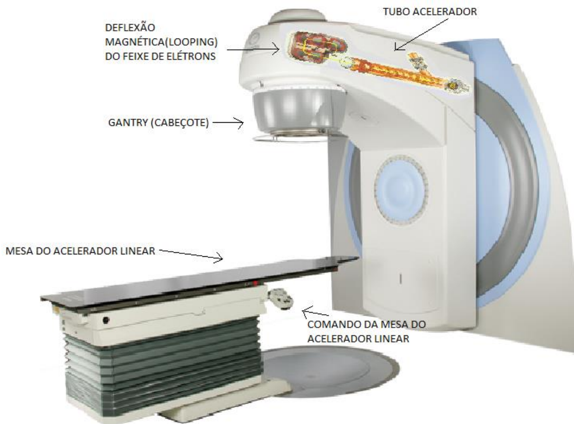
Figura 1: Representação de um Acelerador Linear e seus principais componentes
